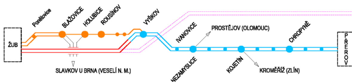
Obrázek 22 Navržené kolejové schéma trati – varianta S4
