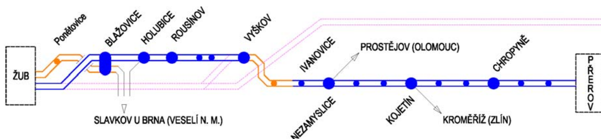
Obrázek 34 Navržené kolejové schéma trati – varianta K3
