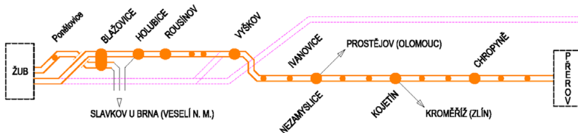
Obrázek 10 Navržené kolejové schéma trati – varianta O2+
