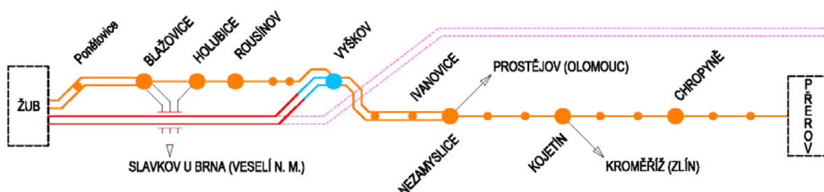
Obrázek 19 Navržené kolejové schéma trati – varianta S1
